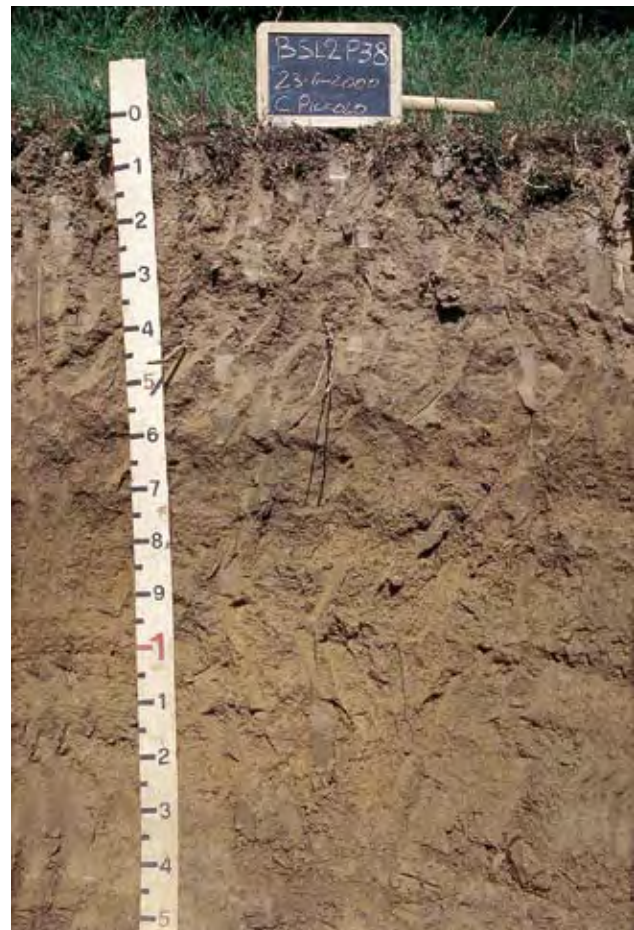
Fig. 5B.9: Suolo a granulometria limoso fine ( Calcaric Cambisol ) tipico della pianura indifferenziata.
