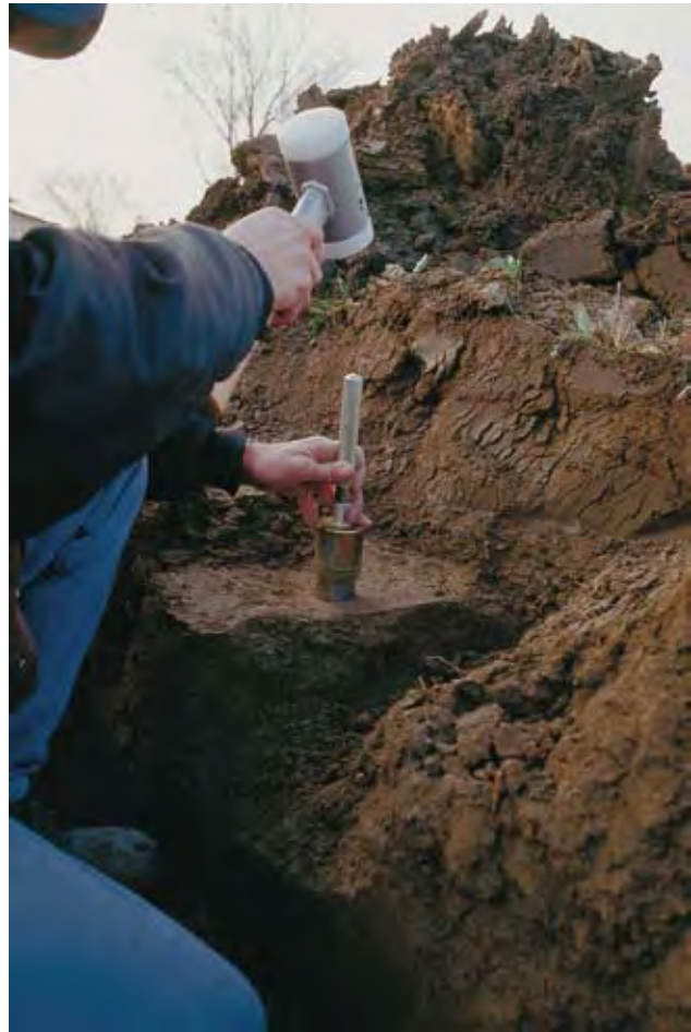
Fig. 7.12: Prelievo di campioni indisturbati con cilindri di volume noto.
