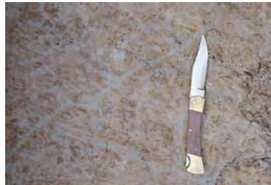
Sezione del suolo Zerman a circa 100 cm di profondità: sono evidenti le screziature grigie in corrispondenza delle superfici planari tra gli aggregati, vie preferenziali per il movimento dell'acqua.
