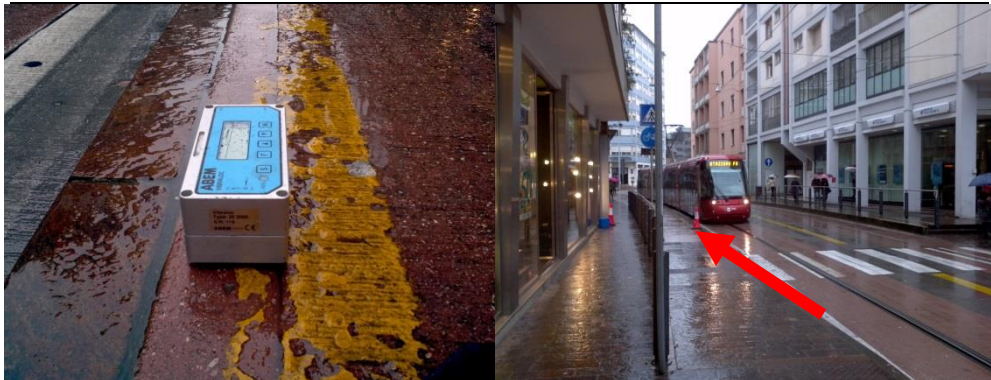
Terna triassiale in posizione adiacente alla via di corsa - Vibracloc n°119
