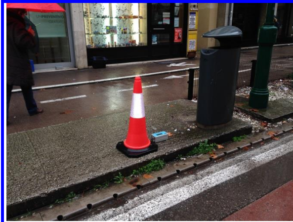
Vibriloc in vicinanza della via di corsa del tram
