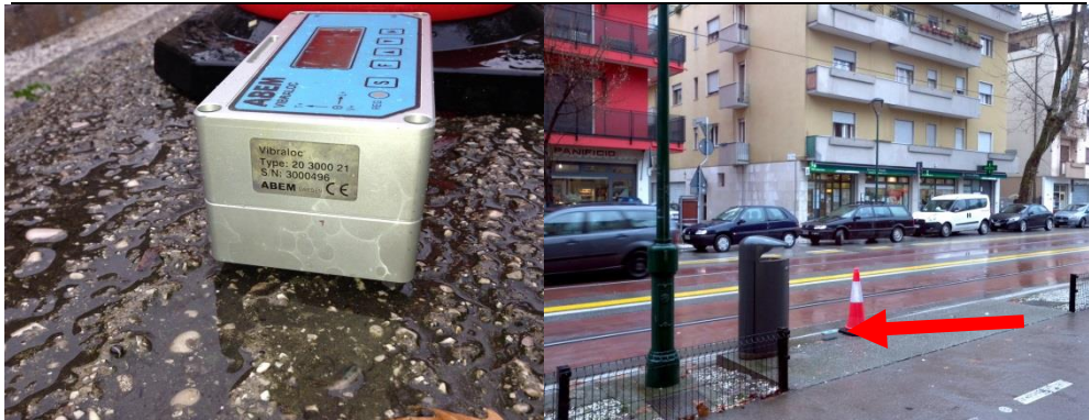
Terna triassiale in posizione adiacente alla via di corsa - Vibraloc n°496
