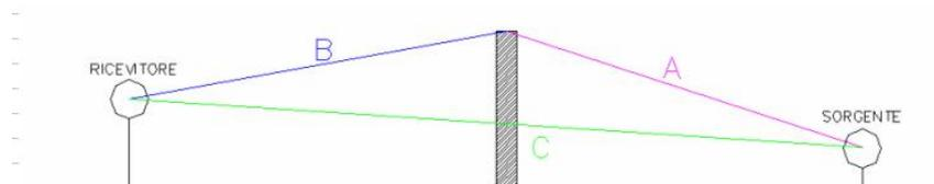
L'applicazione del modello porta alla definizione che la maggiore efficacia della barriera si ha nei confronti dell'area di frantumazione/vagliatura terre (aree 7xx) in quanto sussiste una distanza ridotta fra componente e barriera, con valori di riduzione calcolabili su valori di 15 dB. Tale valore risulta efficace nei confronti delle direzioni di propagazione ove è presente la barriera ossia le direzioni ovest, nord ed est.
