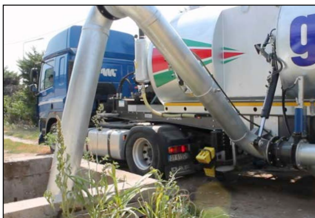
Esempio di sistema di caricamento di fanghi mediante sorbola della botte
