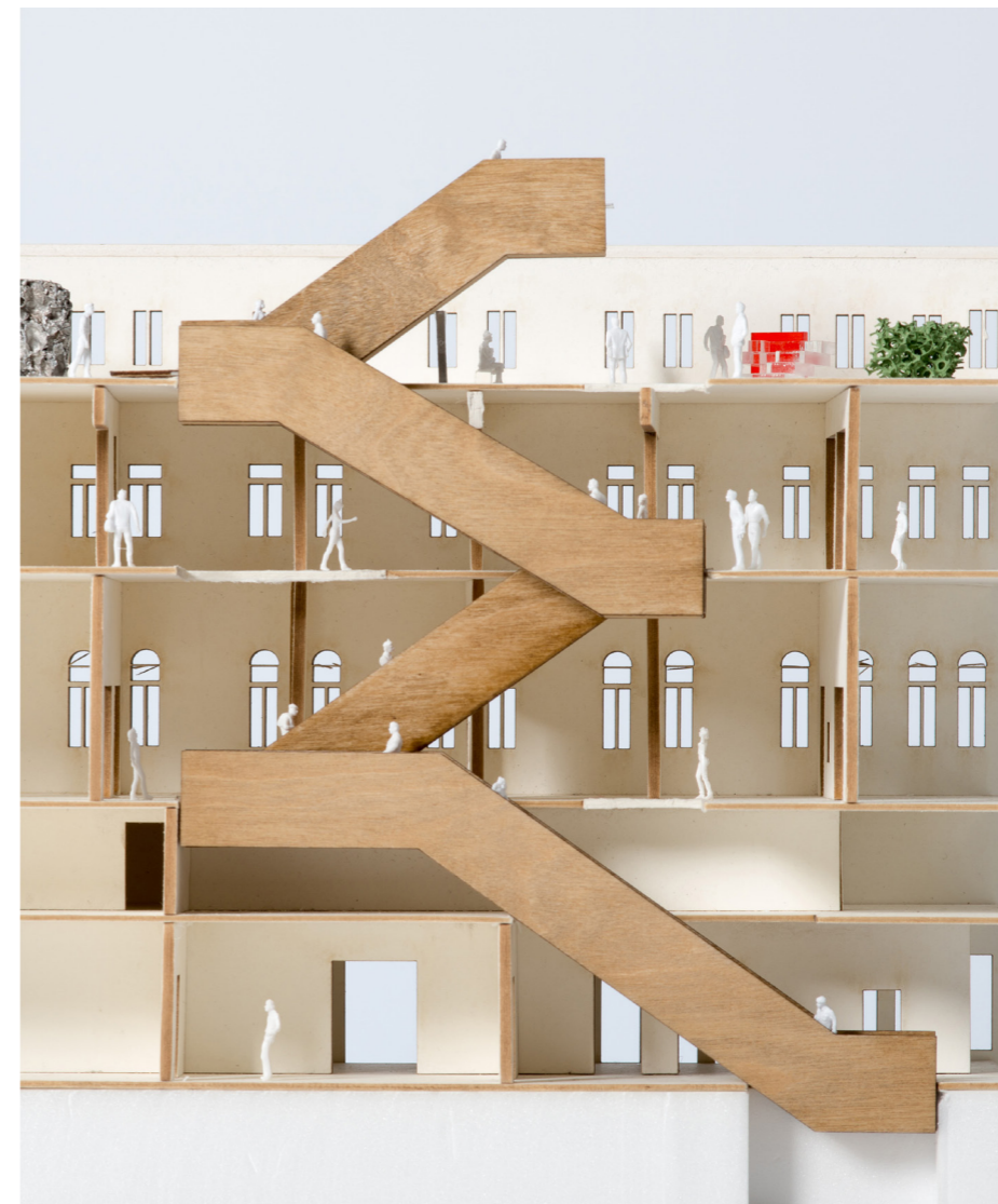
Sezione del plastico di progetto che evidenzia il funzionamento delle scale mobili
