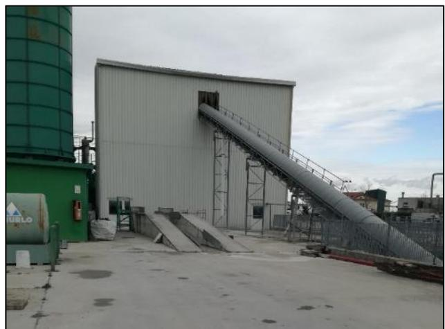
*Fig. 8: Nastro trasportatore*
