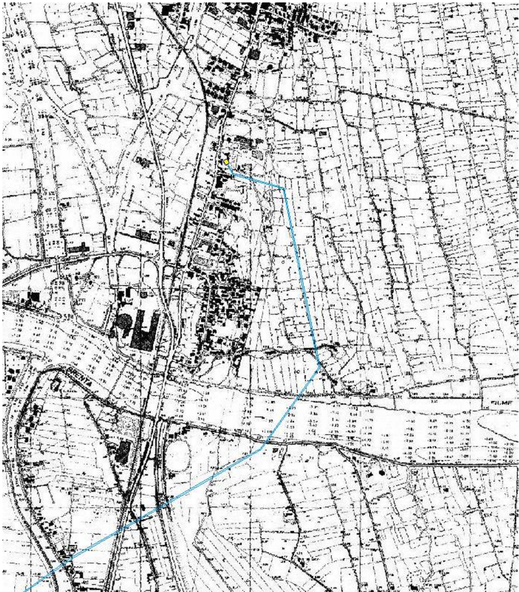
Immagine n° 85 – Elettrodotto da 132 kW: tratte di elettrodotto con tensione di esercizio di 132 kV (alta tensione (fonte: progetto SITA, Provincia di Venezia)
