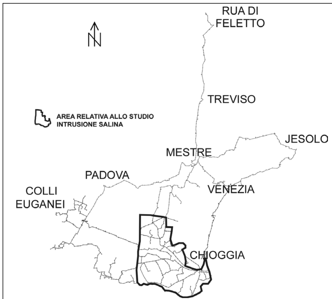
Fig. 2 - Progetto ISES: schema della rete di monitoraggio altimetrico e dell'area di interesse del sottoprogetto Intrusione Salina.
