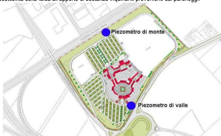
Planimetria indicante i piezometri per l'estrazione dei campioni di monitoraggio delle acque sotterranee.
