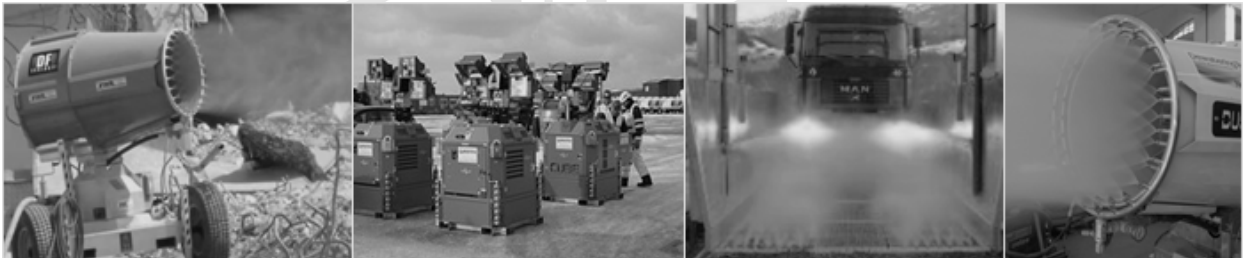
Esempio di soluzioni adottate dalla scrivente: Dust Fighter e Wheel Washing per il contenimento delle polveri
