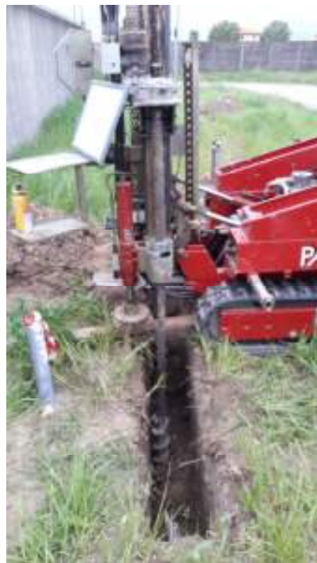
prova CPT F4 e preforo F1
