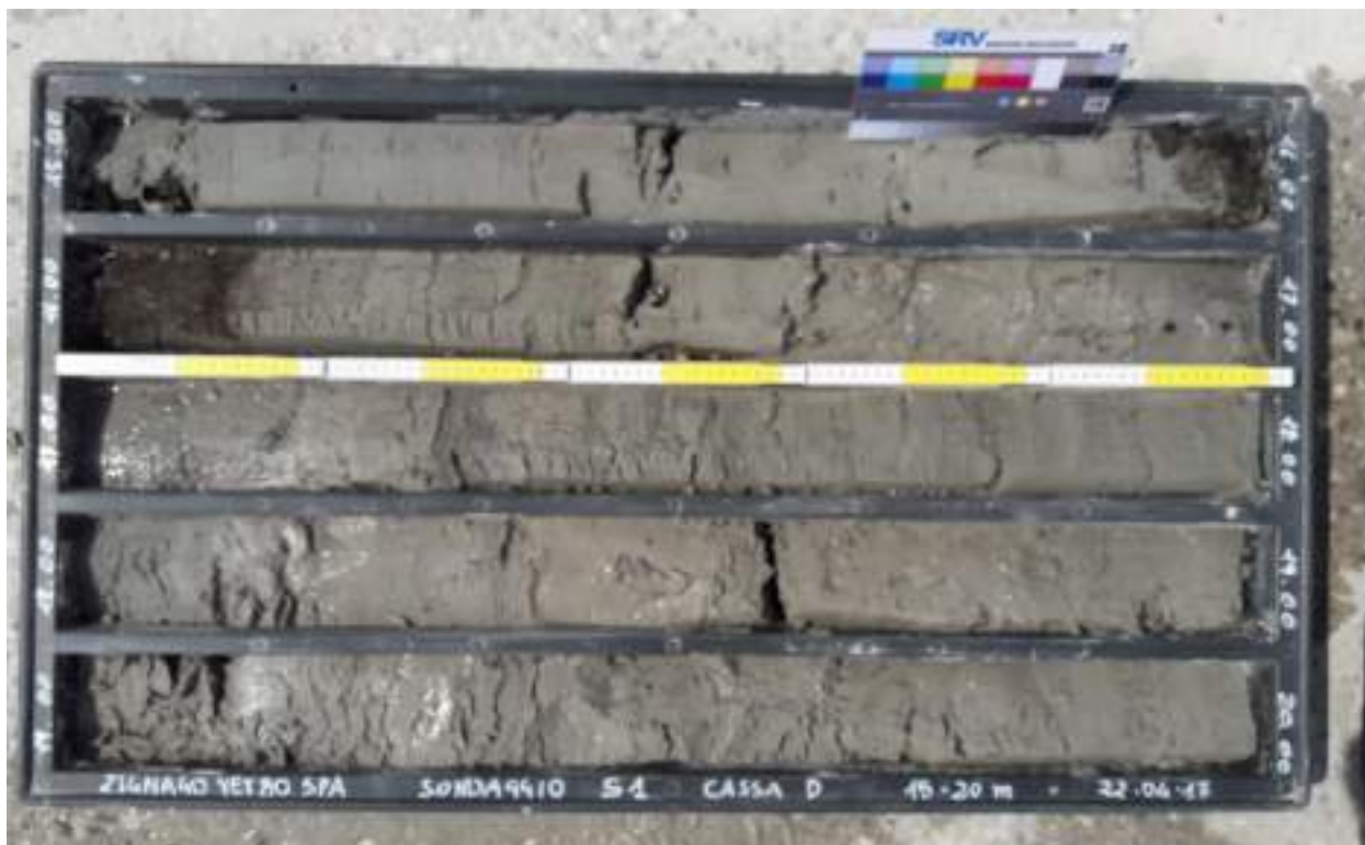
Sondaggio S1, Cassetta C: da 10.0 a 15.0 metri.
