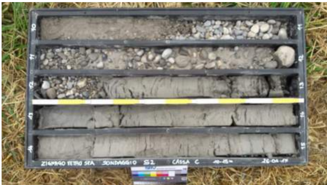
Sondaggio S2 Cassetta C: da 10.0 a 15.0 metri.
