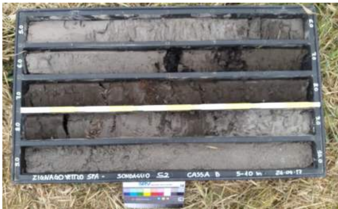
Sondaggio S2 Cassetta B: da 5.0 a 10.0 metri.
