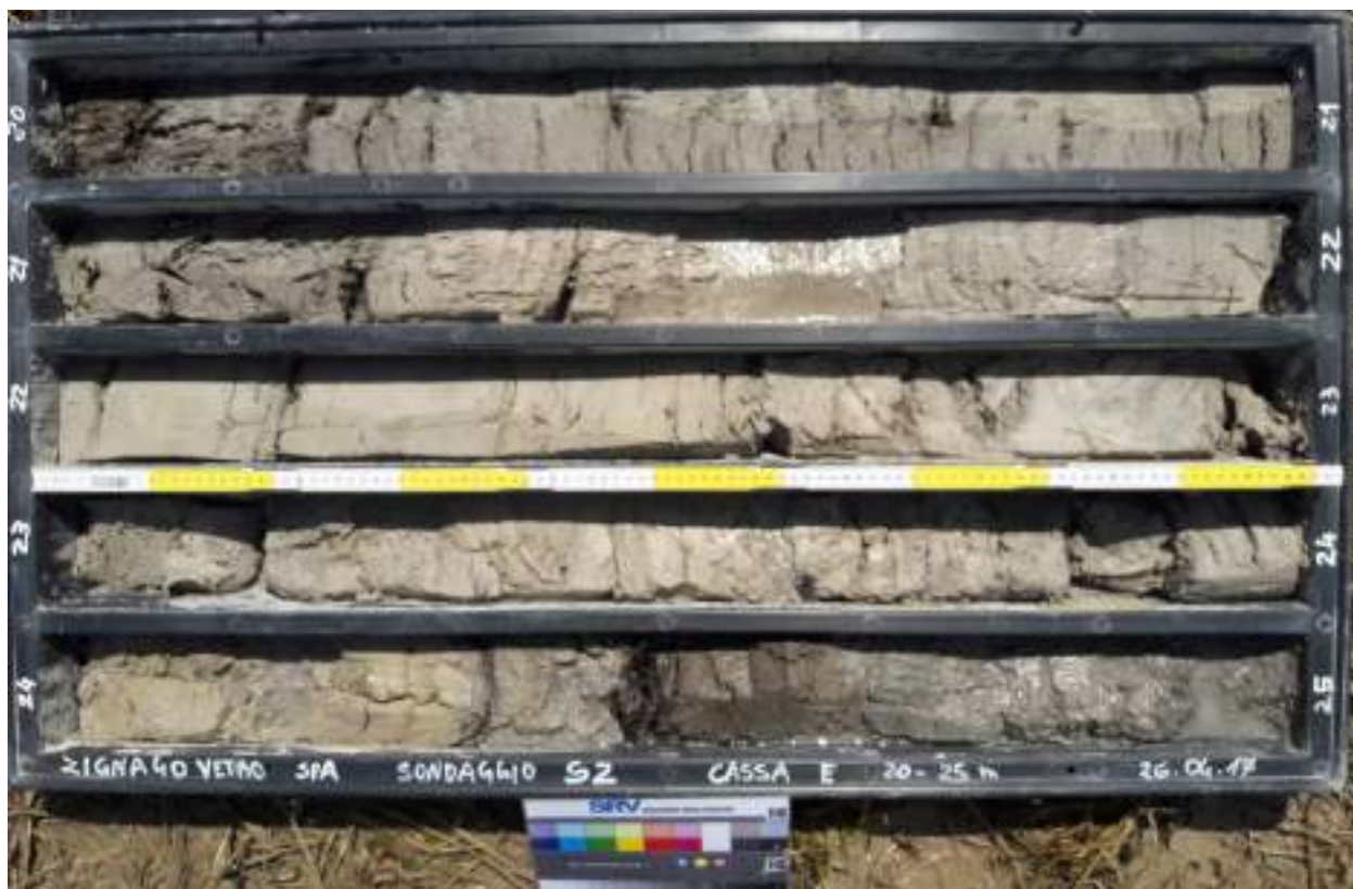
Sondaggio S2 Cassetta E: da 20.0 a 25.0 metri.
