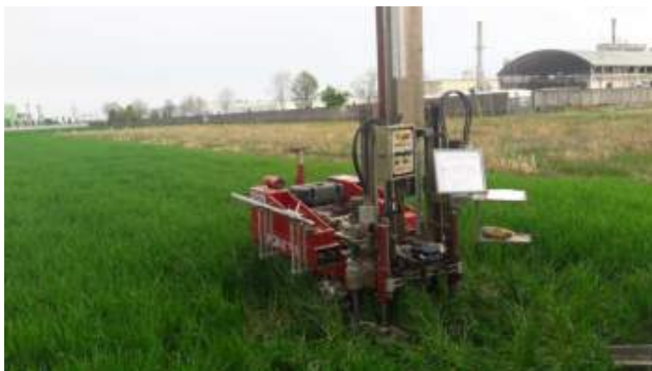
Esecuzione prova CPT RN1 su terreno naturale.
