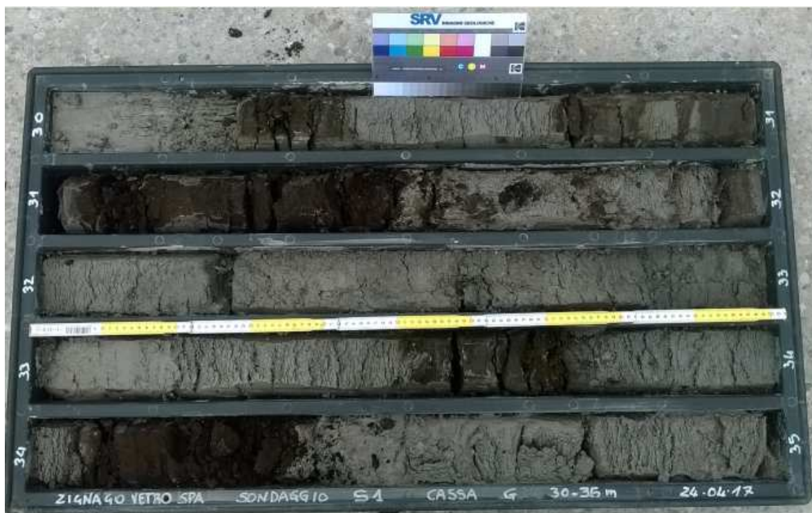
Sondaggio S1, Cassetta G: da 30.0 a 35.0 metri.
