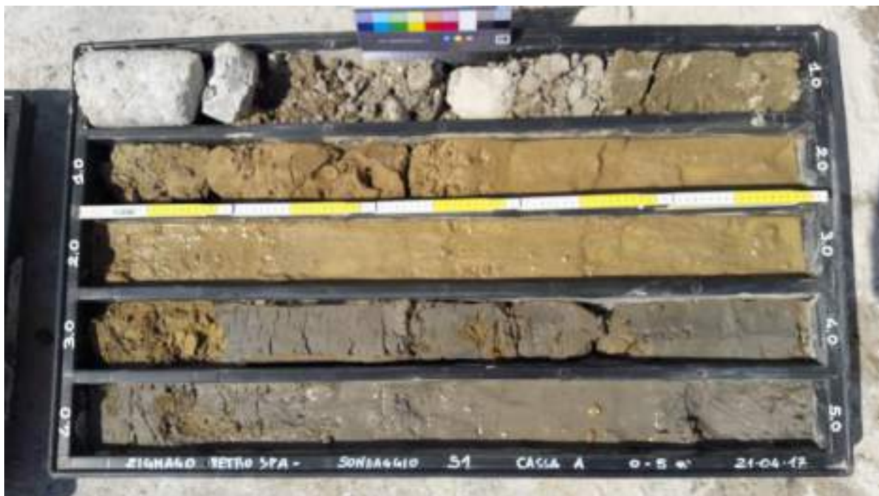
Sondaggio S1, Cassetta A: da 0.0 a 5.0 metri.
