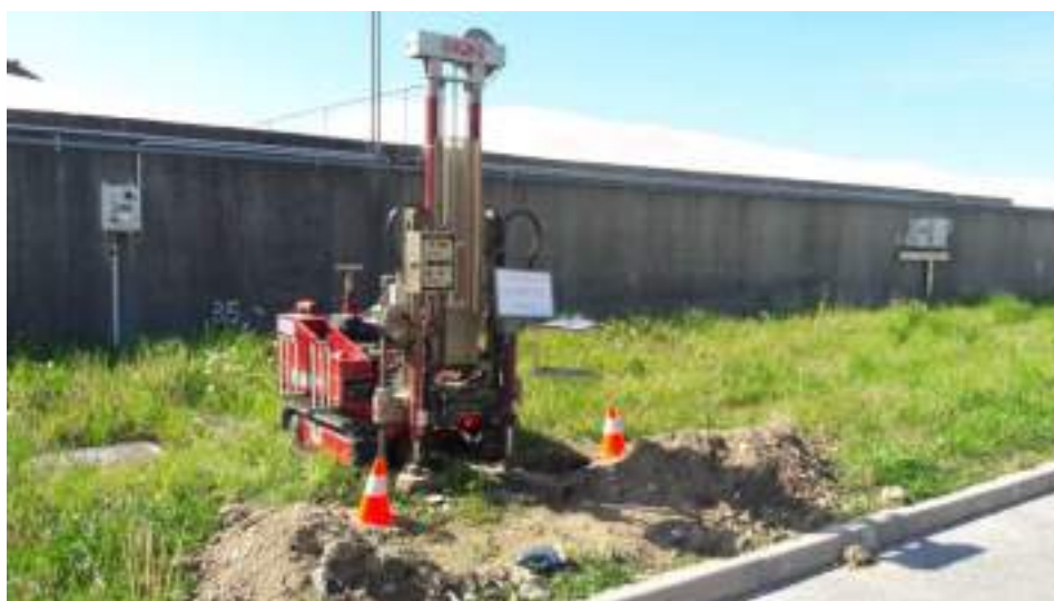
Esecuzione prova CPT F3 con preforo in trincea su terre compatte.
