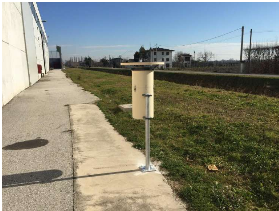
Deposimetro DP2 – in prossimità del lato sud-est dello stabilimento, confinante con via Emilia.
