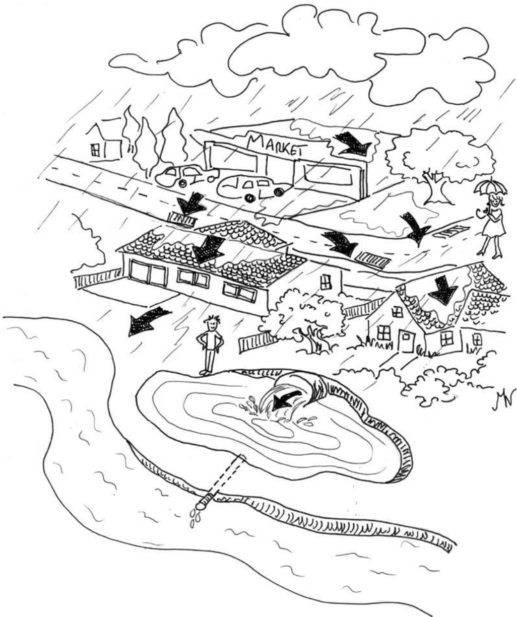
La creazione di invasi di laminazione contribuisce a ridurre le portate di piena (tratto da: I Piani delle Acque , Provincia di Venezia, 2011).
