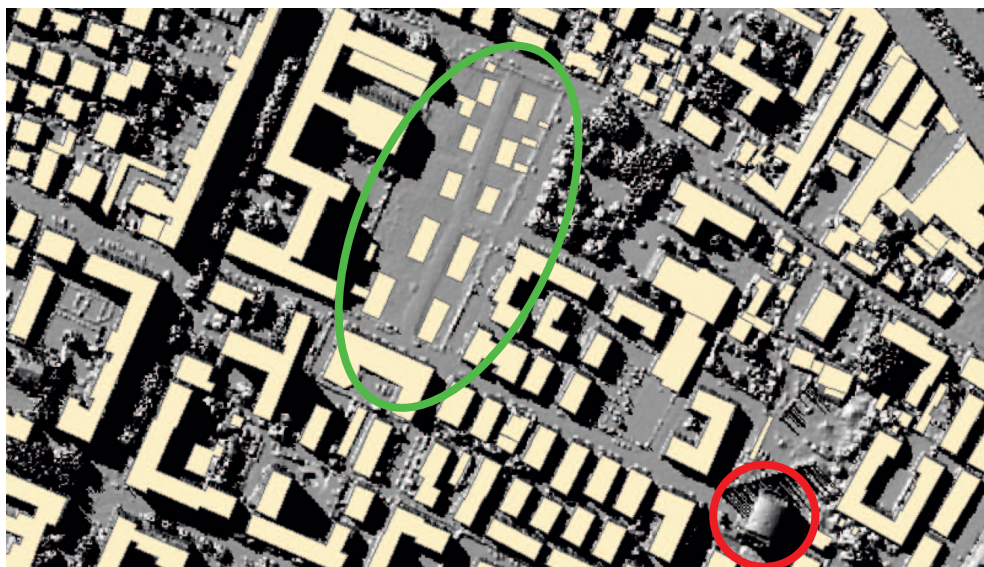
Figura 45 - Esempio di individuazione di un edificio non ancora presente nelle banche dati vettoriali relative all'edificato (cerchio rosso); esempio di edifici presenti nel db vettoriale ma non più esistenti (ovale verde).
