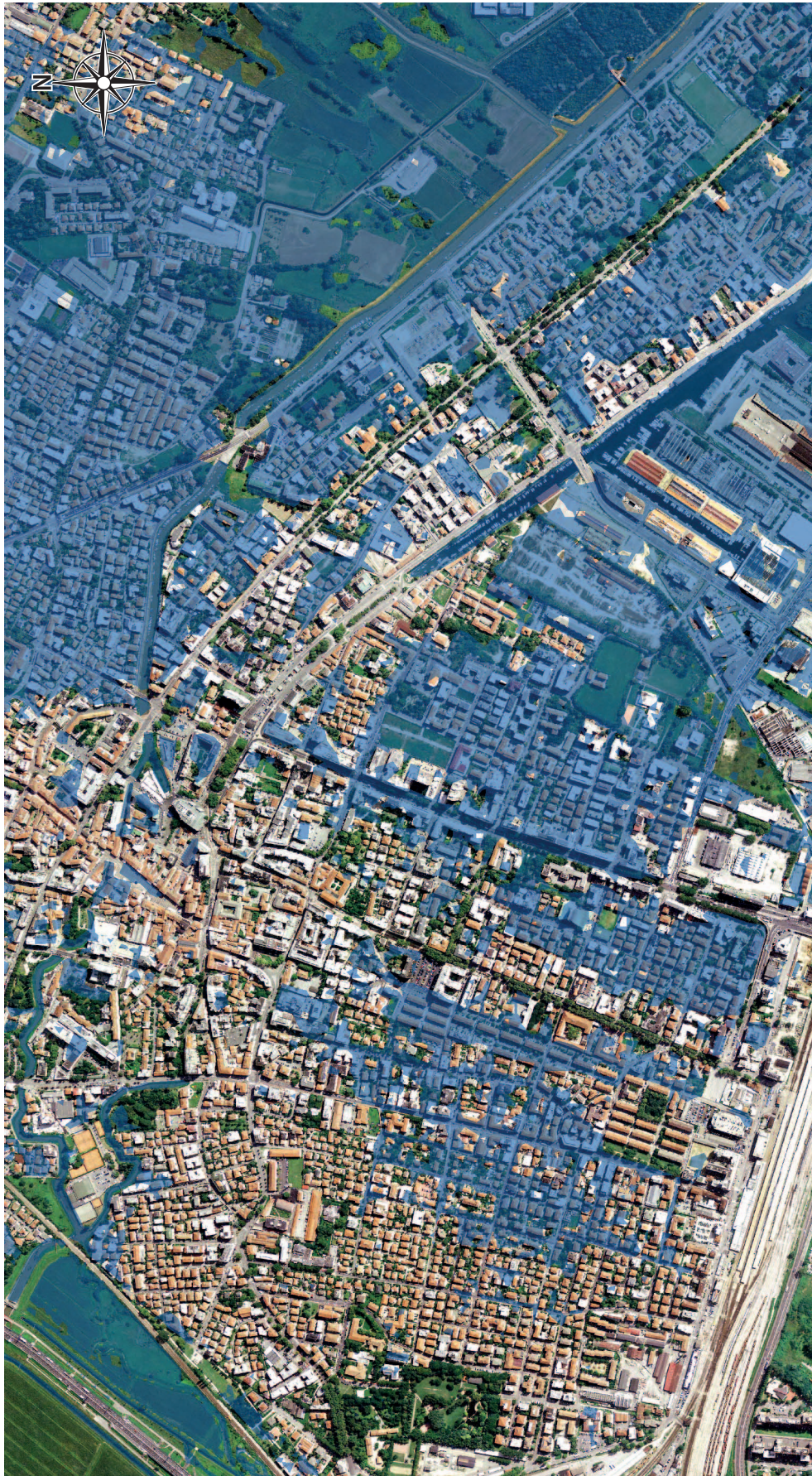
Figura 1 - Analisi speditiva delle aree con quote depresse (in azzurro) basata sul DTM generato dal dato LiDAR nell'area di Mestre.
