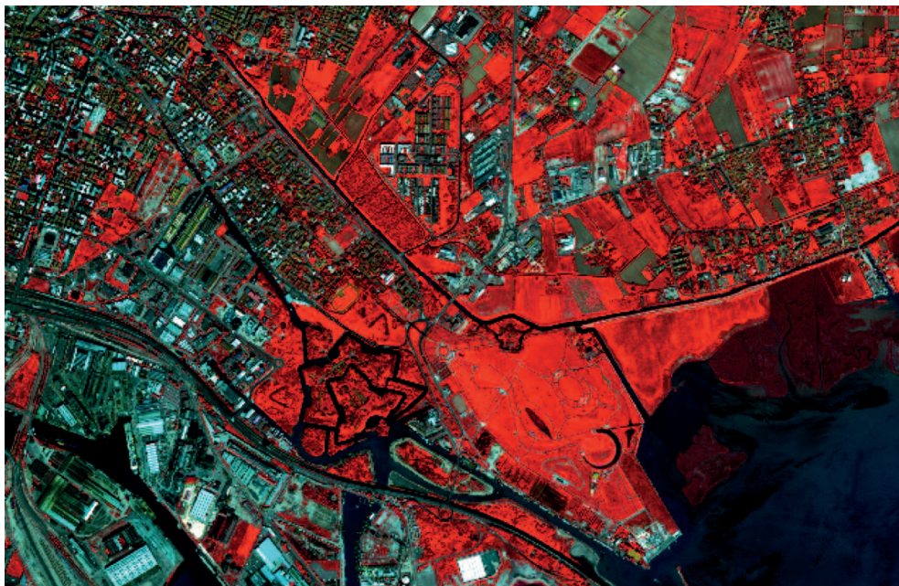
Figura 39 - La serie di immagini prodotte da piattaforme aeree e satellitari consente di effettuare accurate classificazioni per l'estrazione di tematismi come la vegetazione, l'acqua, i suoli impermeabili, le aree agricole ecc. L'immagine multispettrale a 8 bande è tratta da una scena WorldView-2 acquisita il 2 aprile 2010 con una risoluzione spaziale di 50 cm per pixel.
