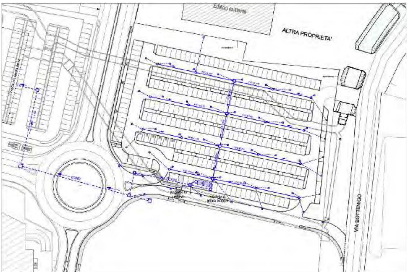
Figura 5.7 – Planimetria parcheggio schema acque bianche realizzata
