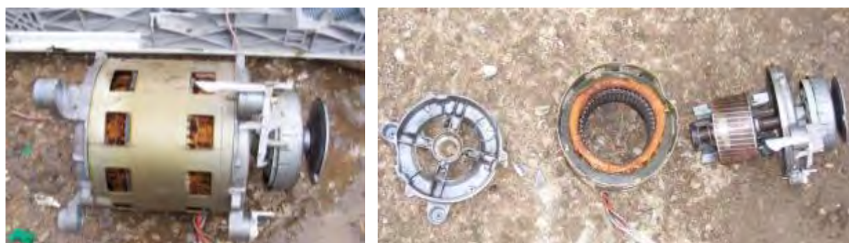
Figura 13 – Immagini fasi di smontaggio motore elettrico
