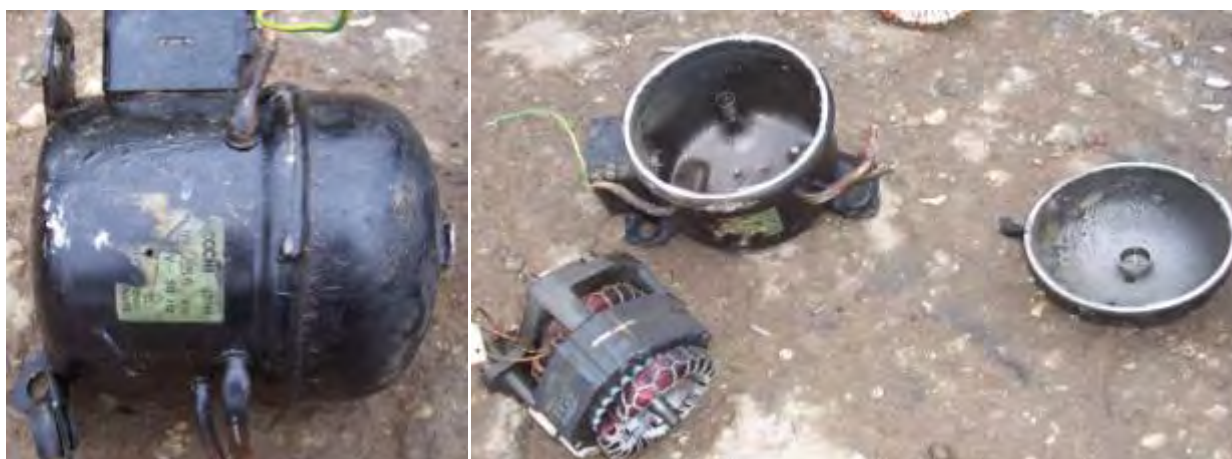
Figura 12 – Immagini fasi di smontaggio compressore
