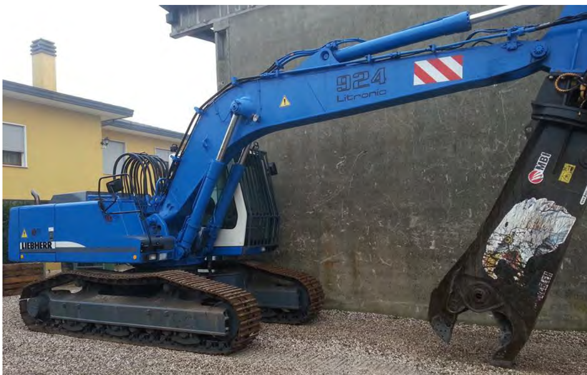
Figura 26 – Immagine dell'escavatore e della pinza-cesoia che saranno utilizzati dalla Maniero Luigi.
