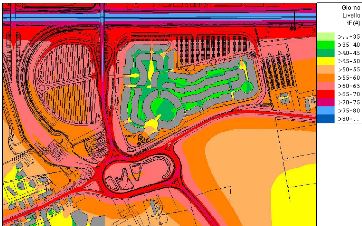
Rappresentazione dell'isolivello sonoro simulato Laeq (dBA) diurno a Q.+4,00 – PROGETTO
