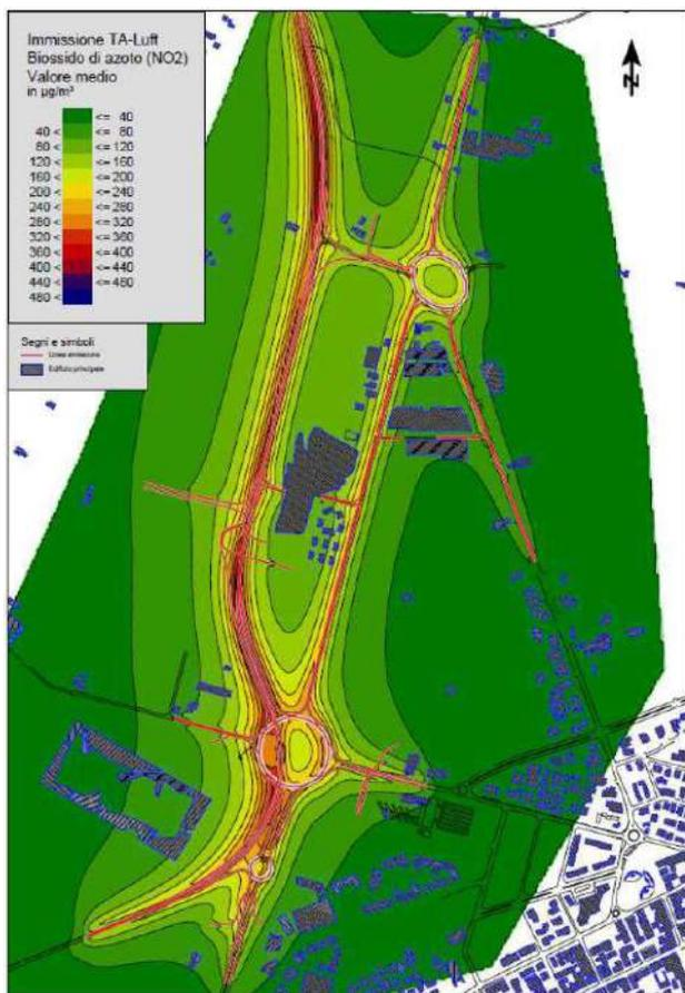
Concentrazione atmosferica NO<sub>2</sub> per l'altezza dal suolo di 2.5 m (Fonte: Studio di Impatto Atmosferico).
