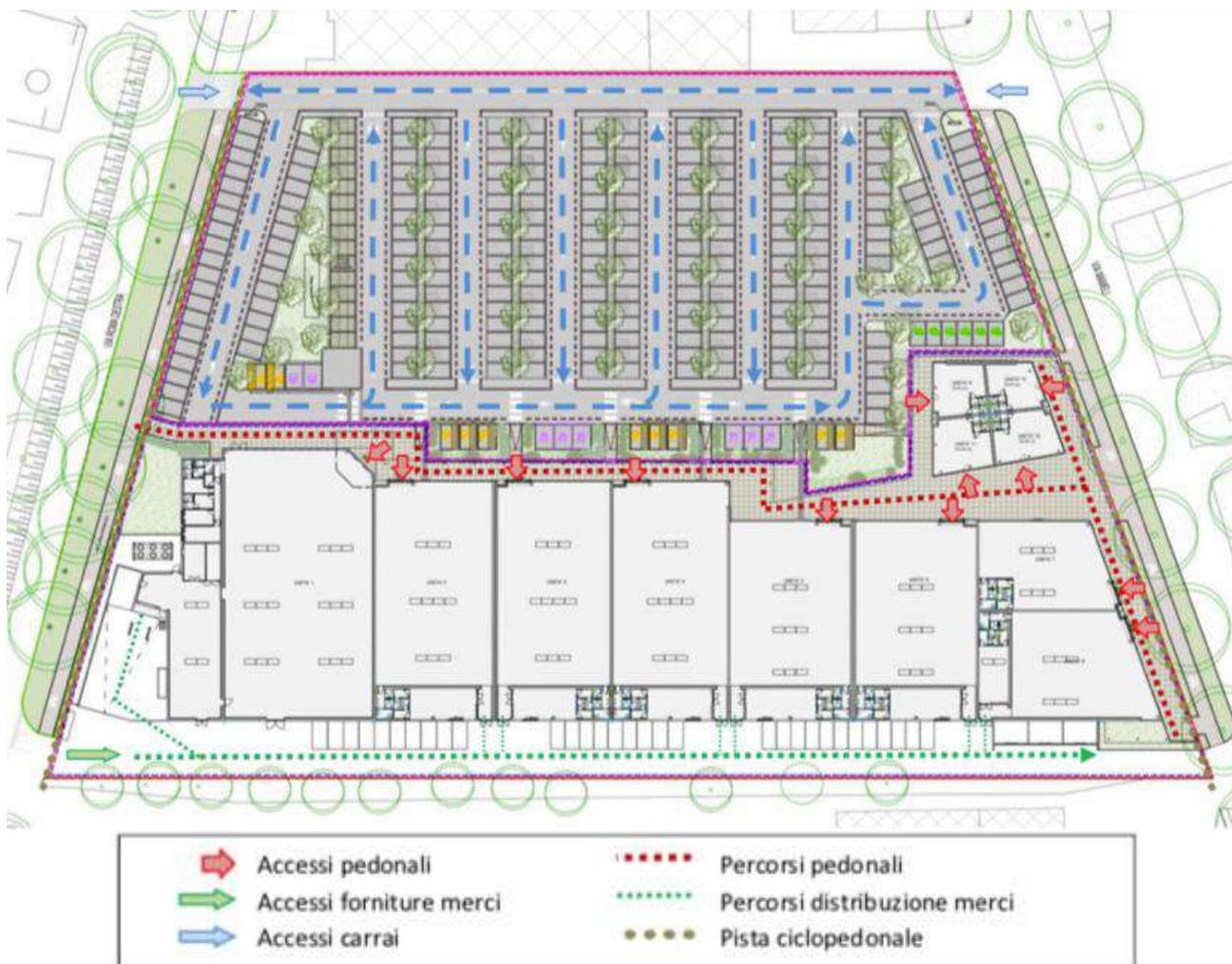
*Planimetria di progetto indicante flussi di circolazione e accessibilità dell'area.*
