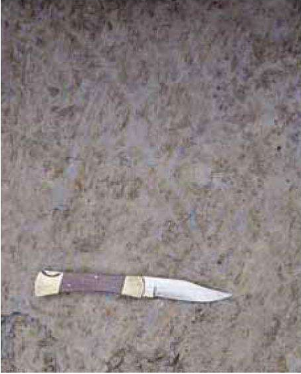
Fig. 5B.22: Sezione dell'orizzonte profondo Bkg con evidenti screziature grigie in corrispondenza delle superfici planari tra gli aggregati, vie preferenziali per il movimento dell'acqua.
