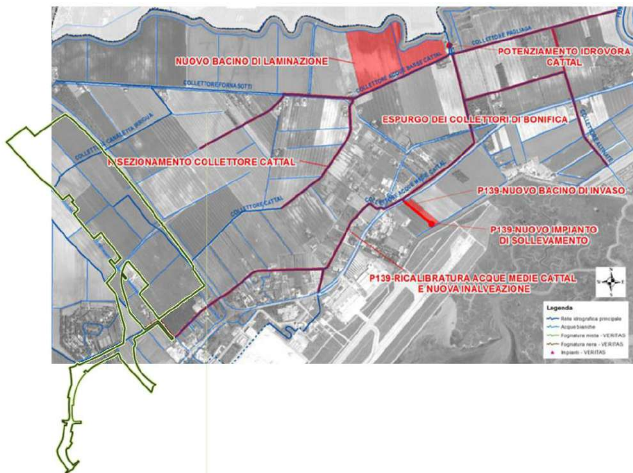
Figura 5-59: Interventi previsti nel Piano delle Acque per risolvere la criticità n. 47 "Idrovora Cattal"
