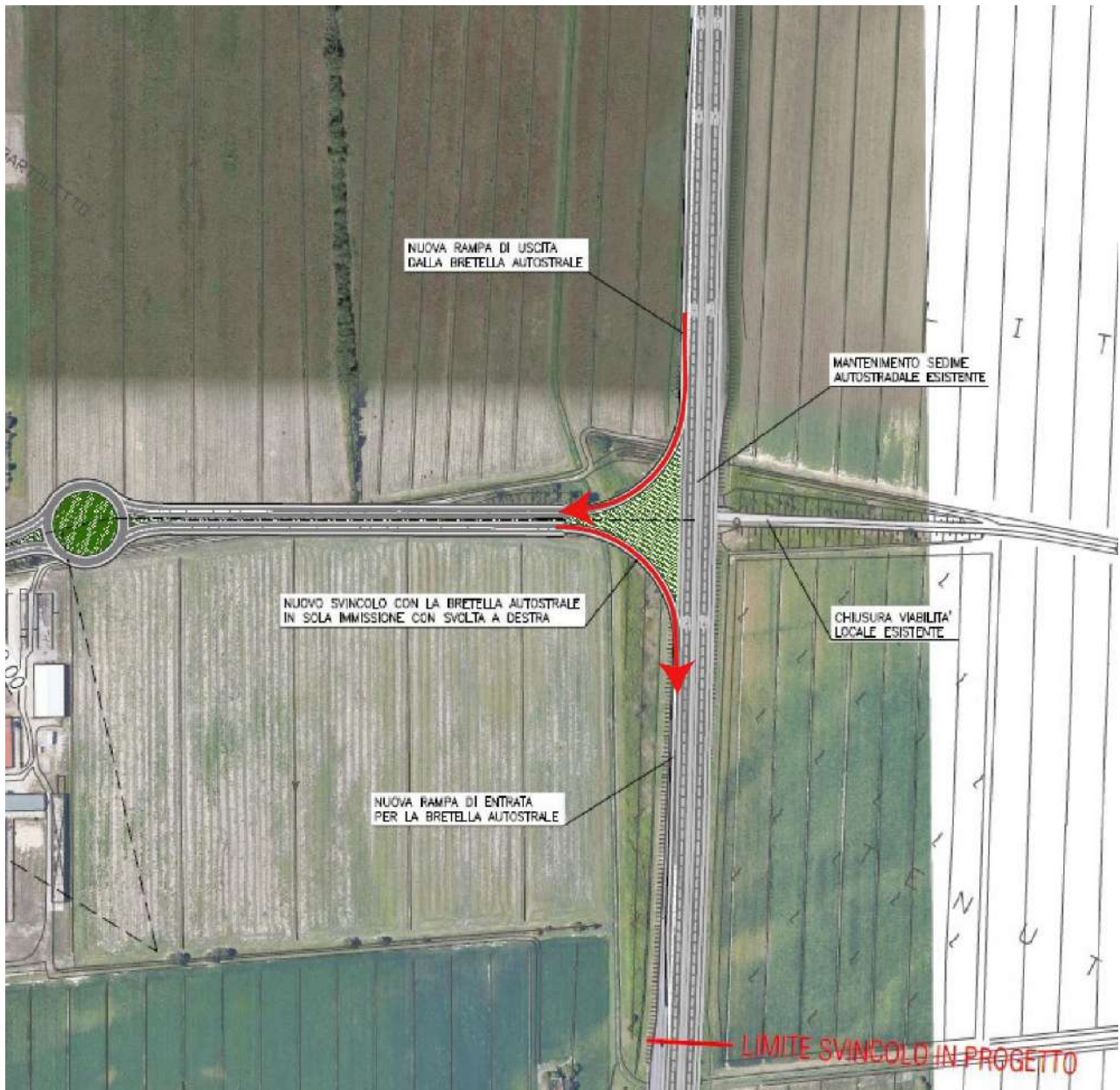
Figura 3-30|ipotesi svincolo sud con la bretella autostradale in sola immissione con svolta a destra
