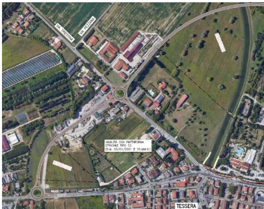
Figura 3-34: Tratto in corrispondenza di via Triestina: ipotesi di risoluzione mediante intersezione a rotatoria tra la viabilità in progetto e la viabilità locale.
