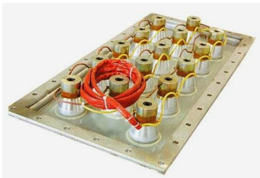
*Particolare trasduttori piezoelettrici per la generazione degli ultrasuoni.*
