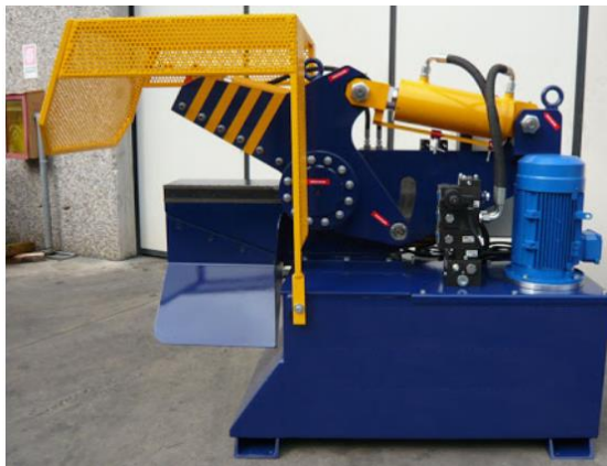
(Rappresentazione fotografica di una cesoia a cocodrillo simile a quella che si intende installare)
