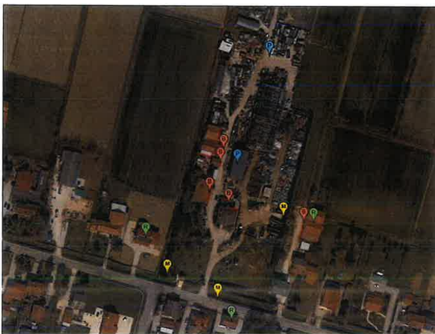
In figura, l'indicazione delle sorgenti (in blu), dei recettori (in verde), delle misure ai recettori (in giallo) e delle barriere (in rosso) presenti considerate per i calcoli fonometrici.
