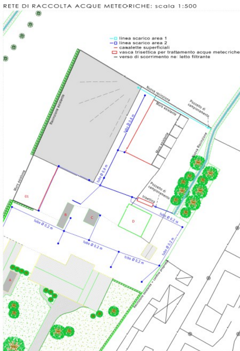
Figura 6: reti di raccolta delle acque meteoriche.
