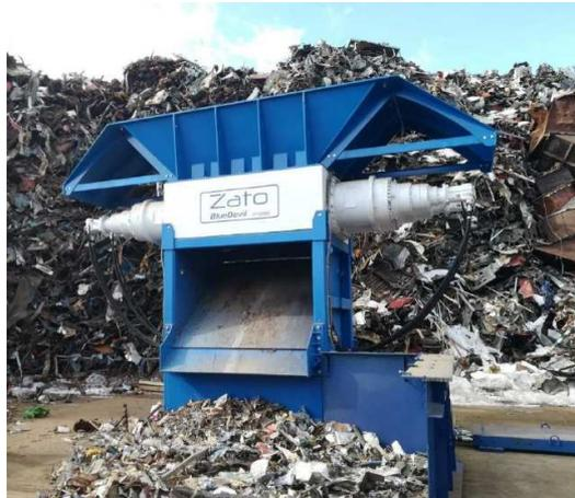
**Figura 5 Nuovo macchinario di riduzione volumetrica (immagine esemplificativa)**
