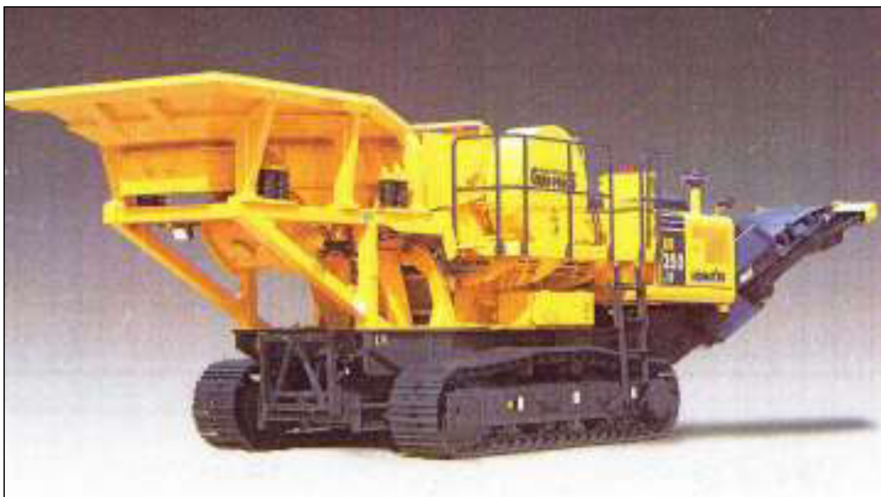
Fig. 8 - Impianto mobile di frantumazione: marca "KOMATSU - mod. BR350JG-1"
