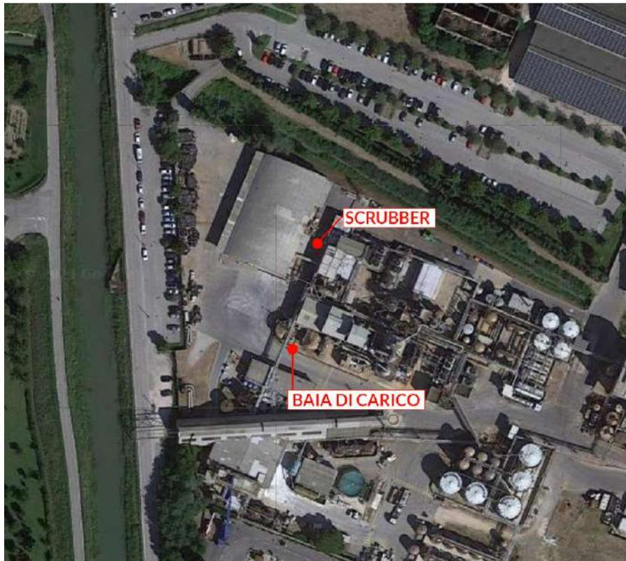
Al fine di identificare con maggior precisione la presenza dei due elementi in oggetto viene presentata in modo schematico una rappresentazione dell'ingombro del nuovo "scrubber", di dimensioni e materiali uguali all'esistente, e con altezza inferiore alla quota di gronda dell'edificio.
