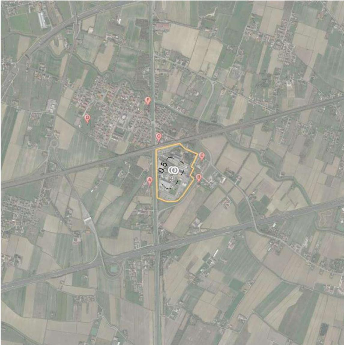
**Figura 9:** mappa del 98° percentile su base annua dell'unità di odore espresse in unità olfattometriche al metro cubo – *simulazione concentrazioni medie.*
