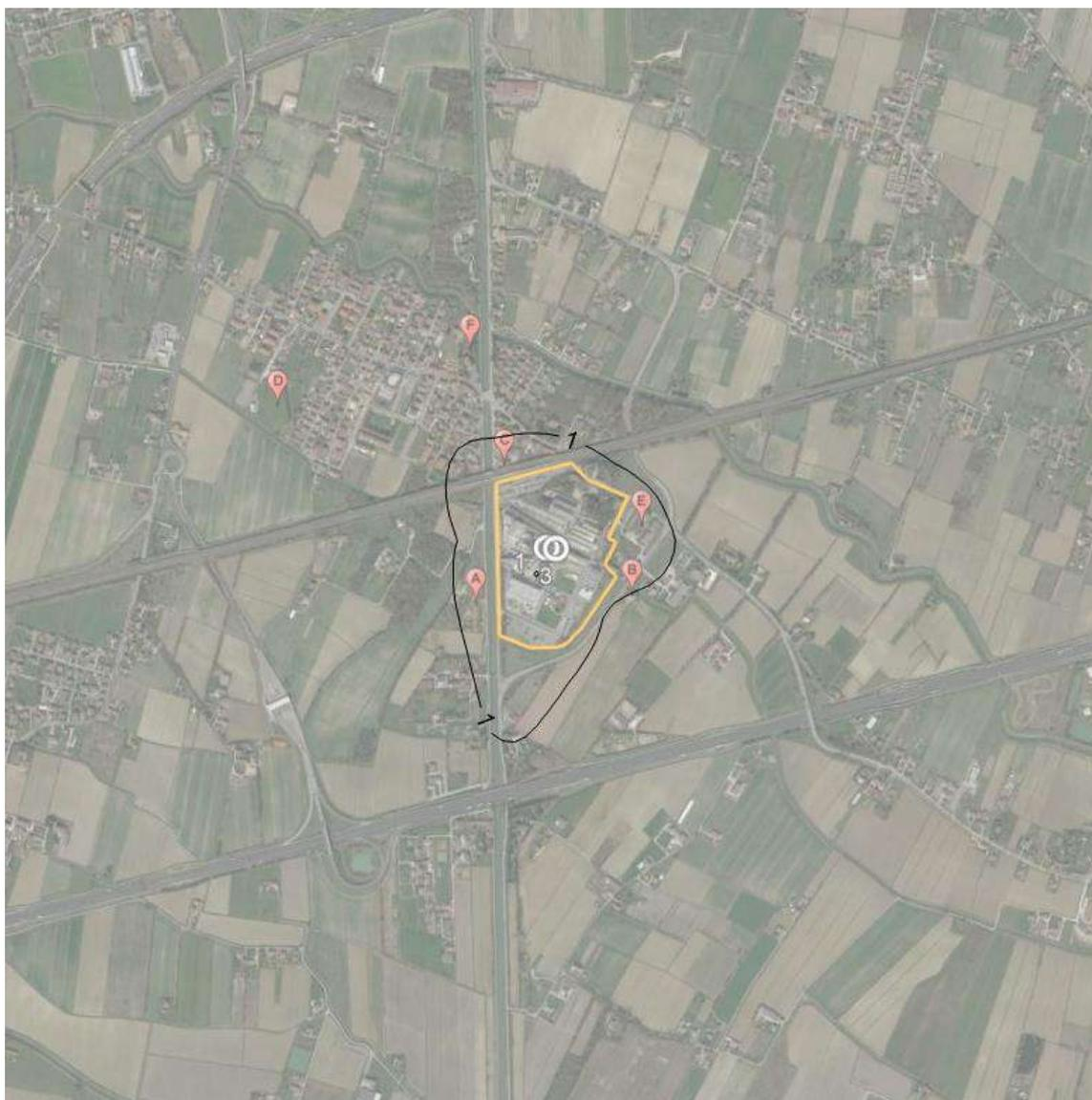
**Figura 10:** mappa del 98° percentile su base annua dell'unità di odore espresse in unità olfattometriche al metro cubo – *simulazione concentrazioni massime.*
