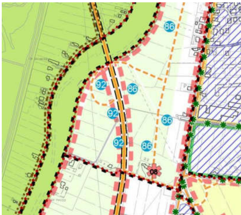
Ingrandimento dell'estratto PAT – Tav. T04 del settore interessato dalla realizzazione della bretella fra SR 43 e SP 42, dove si vede il tracciato schematico della stessa e della rotonda con via Mameli indicati con linee tratteggiate di colore rosa-arancio e spessore differenziato in relazione alla gerarchia territoriale dell'infrastruttura (Fonte: comune di Jesolo).
