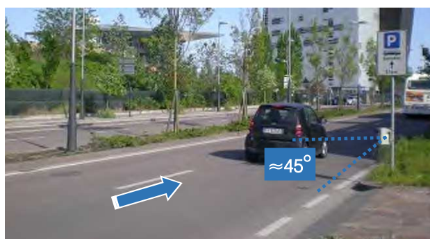
Figura 31 – Angolo di installazione dei radar rispetto alla direzione di marcia
