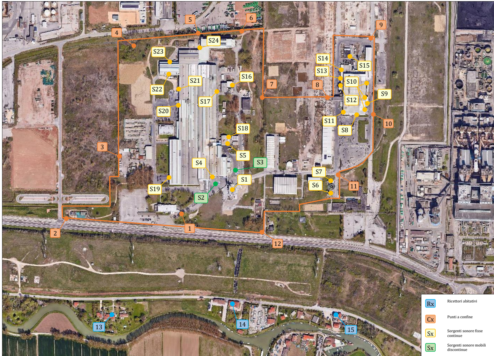
Figura 12.1. Localizzazione misure a confine e presso ricettori e ubicazione sorgenti sonore dello stabilimento
