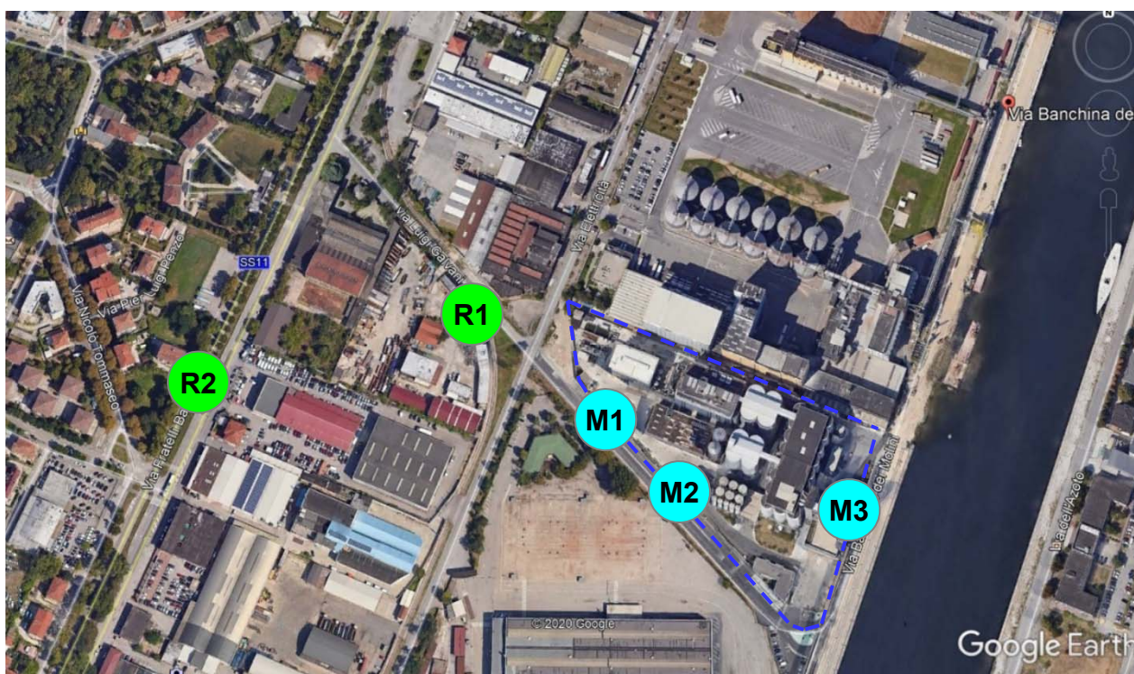
Figura 1. Localizzazione dei punti di misura a confine (Mi) e dei recettori di controllo (Ri)
