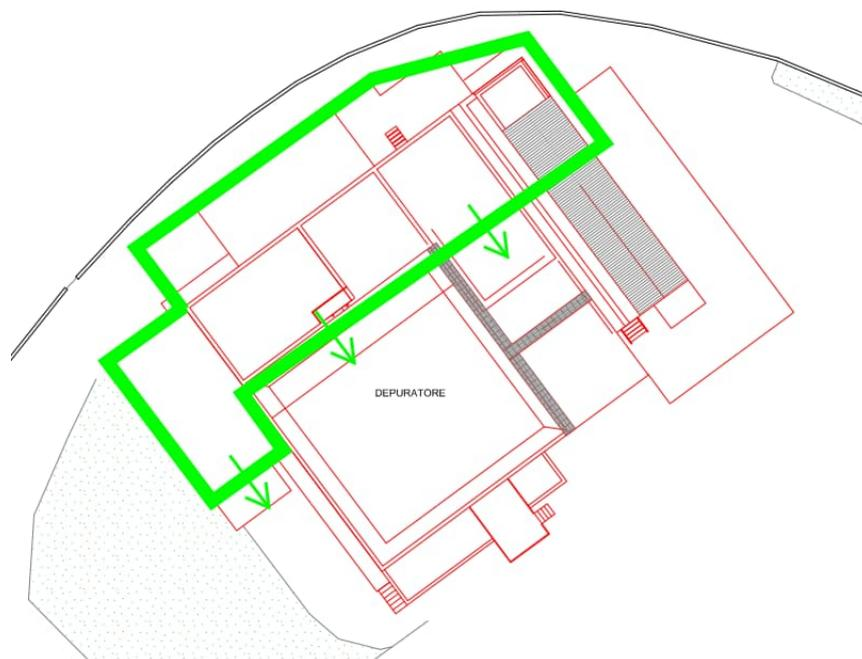
Planimetria della copertura e dei tamponamenti laterali e della copertura del depuratore. Le facciate sud rivolte verso l'interno dello stabilimento indicate con le frecce risultano aperte
