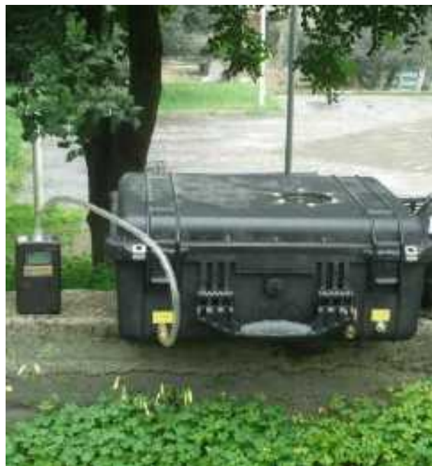
Figura 5.1.1.2-4 VAC-U-Chamber™ in cui è inserito il sacchetto di Nalphan, con pompa a vuoto in attività.
