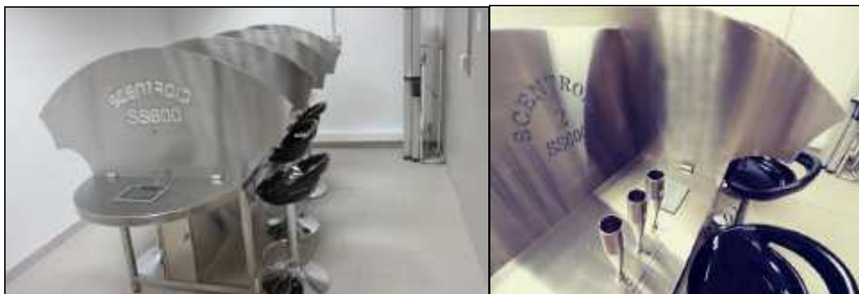
Figura 5.1.1.1-1 Tavolo Olfattometrico Sartec – SCENTROID SS600.
