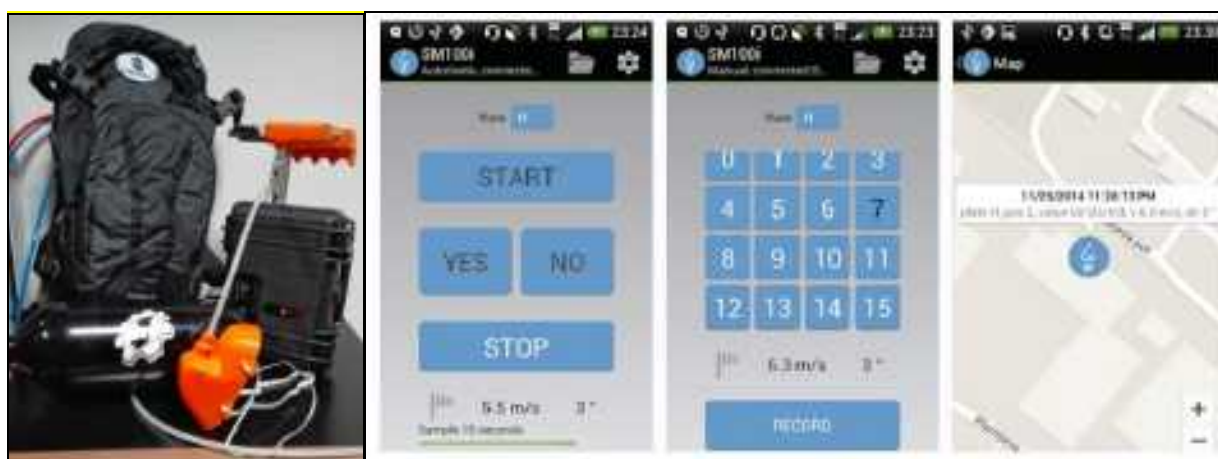
Figura 5.1.2.1.1-2 Sistema di diluizione dell'olfattometro portatile Scentroid SM100 e applicazione SM100i che permette di automatizzare la misura della concentrazione dell'aria ambiente
