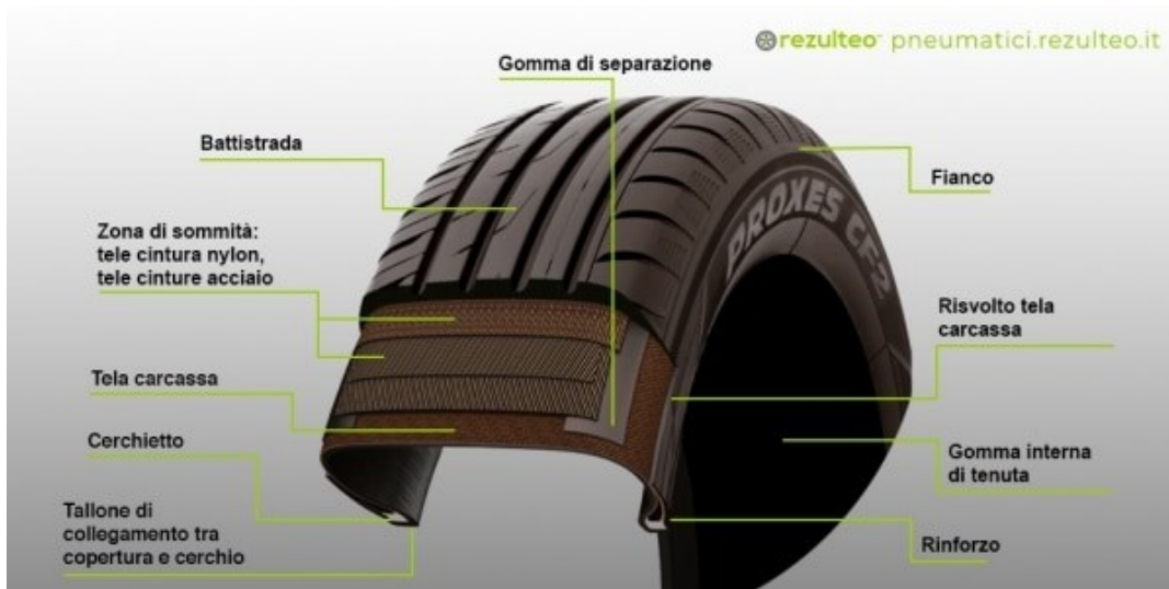
Immagine n. 13 – Struttura di uno pneumatico
