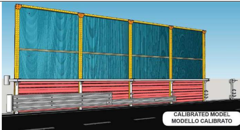
Figura 3 - Tipologico della barriera integrata.
