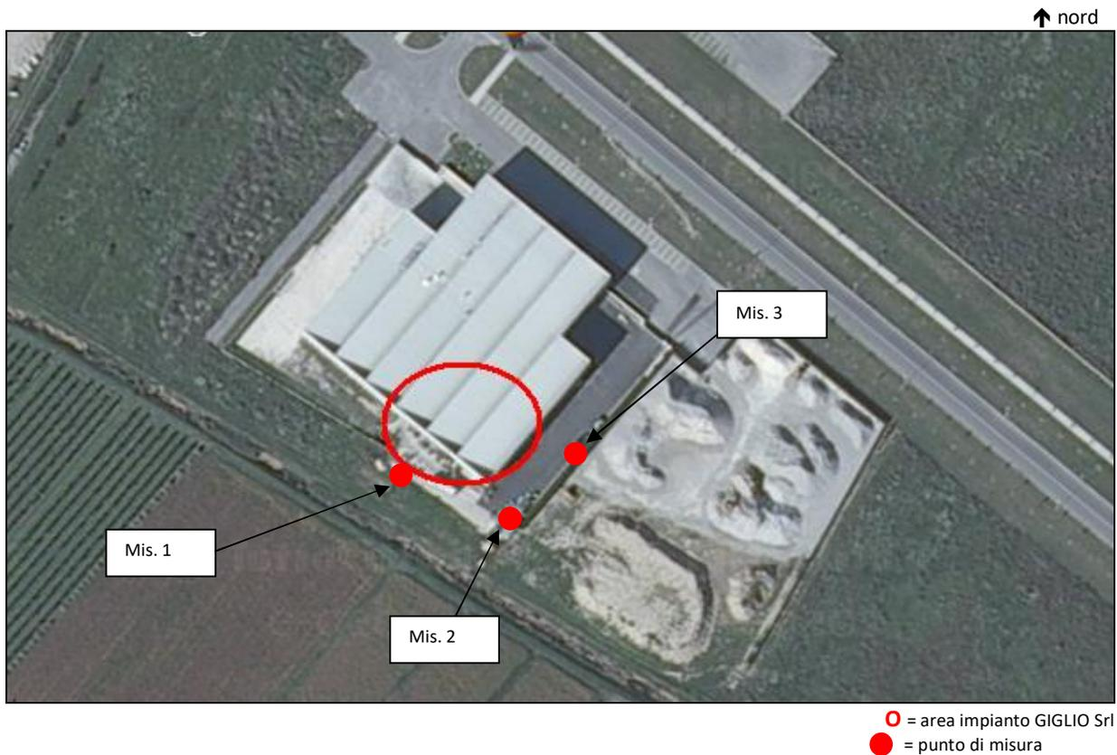
I punti di misura sono stati scelti in quanto ritenuti rappresentativi per il rilievo dei livelli oltre il confine aziendale. In particolare si sottolinea che:
