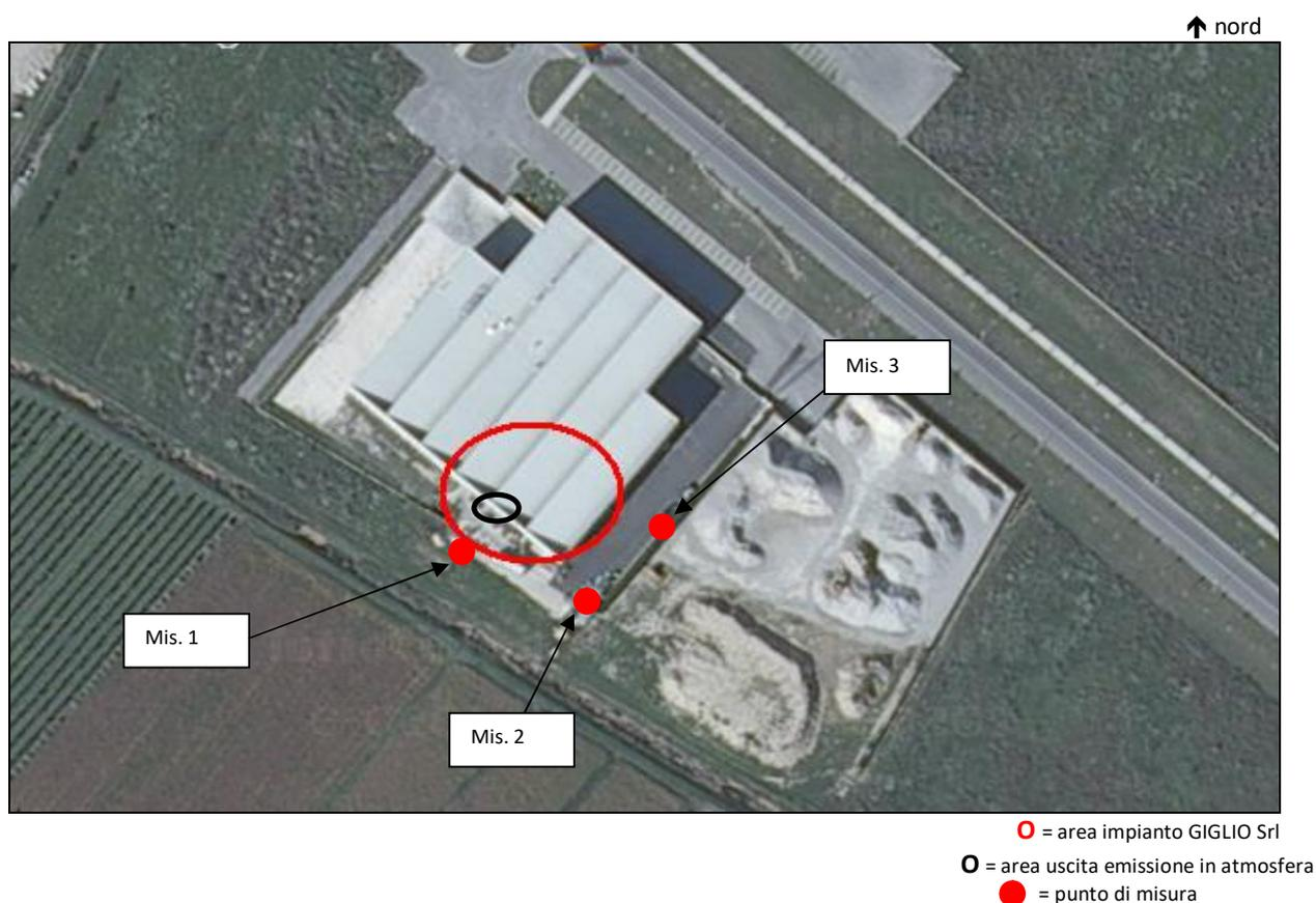
Considerando la collocazione dei punti di misura è ragionevole prevedere che i livelli di progetto associabili ai punti di misura 2 e 3 non subiranno delle variazioni nelle situazioni di progetto. Presso il punto di misura 1 invece, essendo posizionato frontalmente al punto di emissione in atmosfera, è possibile prevedere delle ricadute acustiche associabili a questo nuovo impianto.
