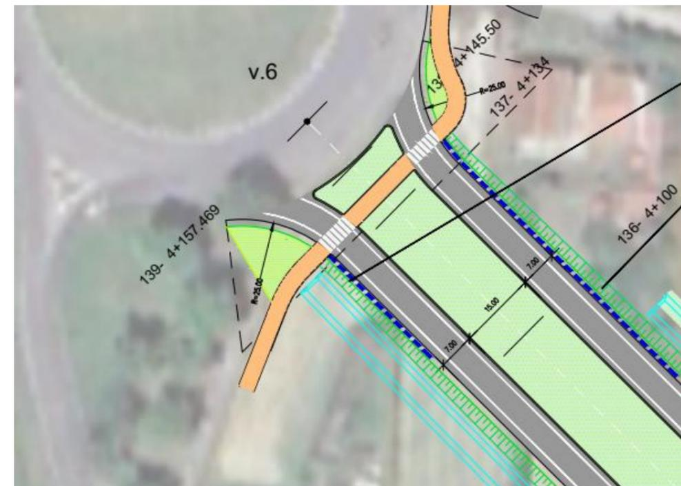
Planimetria del posizionamento delle barriere acustiche in prossimità della rotatoria sulla SP 42.
