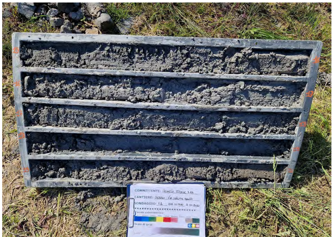
SONDAGGIO S1 CASSA N. 4 DA 15.00 A 20.00 M
