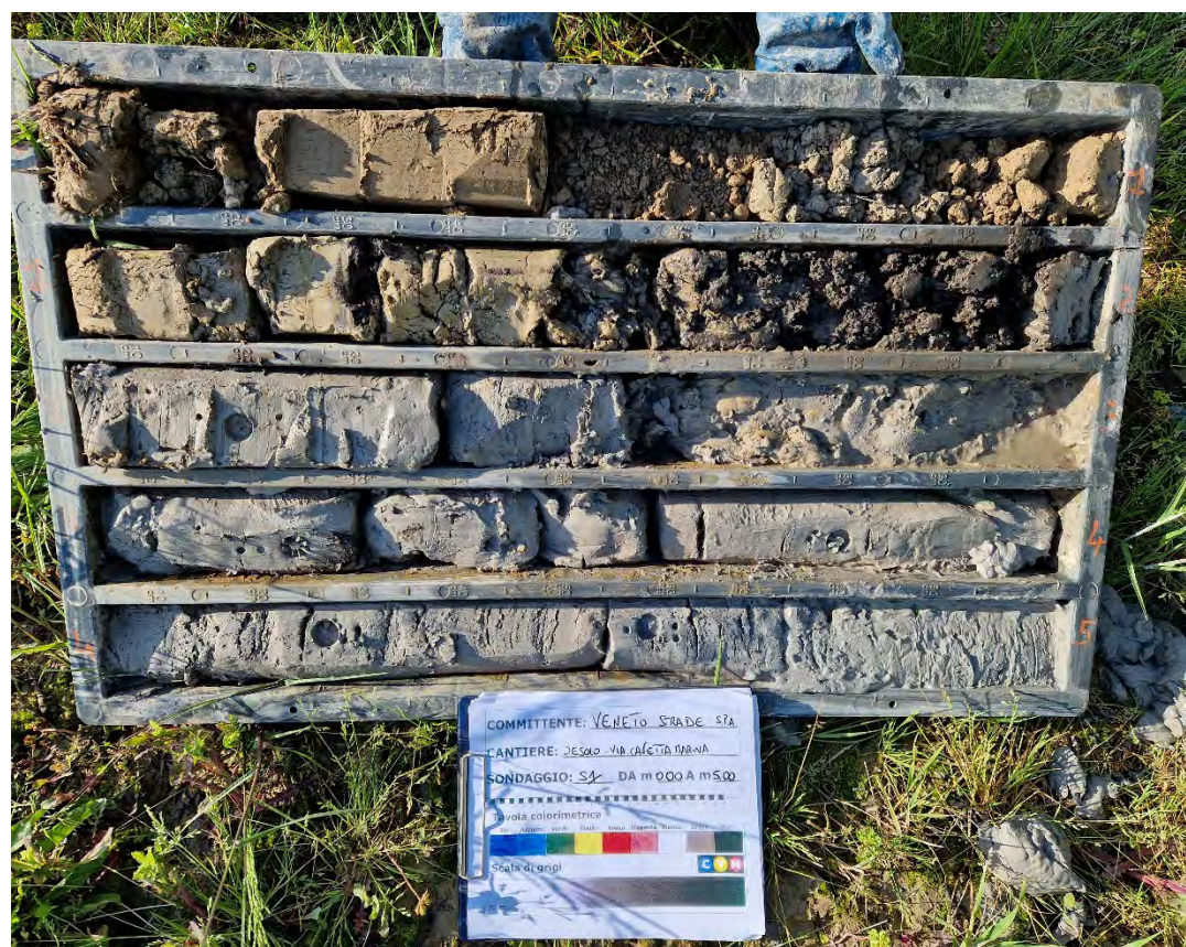
SONDAGGIO S1 CASSA N. 1 DA 0.00 A 5.00 M
