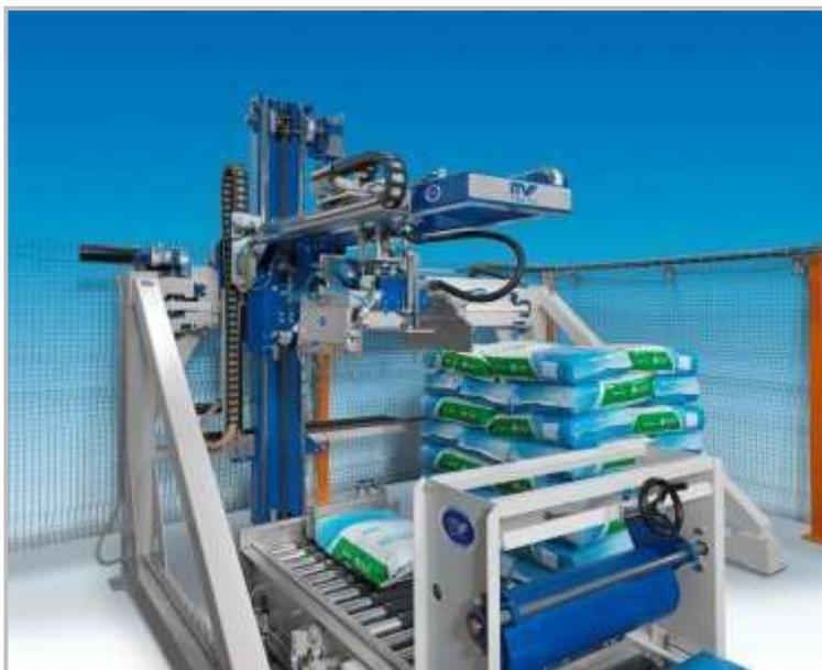
Per l'accesso al pallettizzatore sono previste barriere fotoelettriche di sicurezza.
