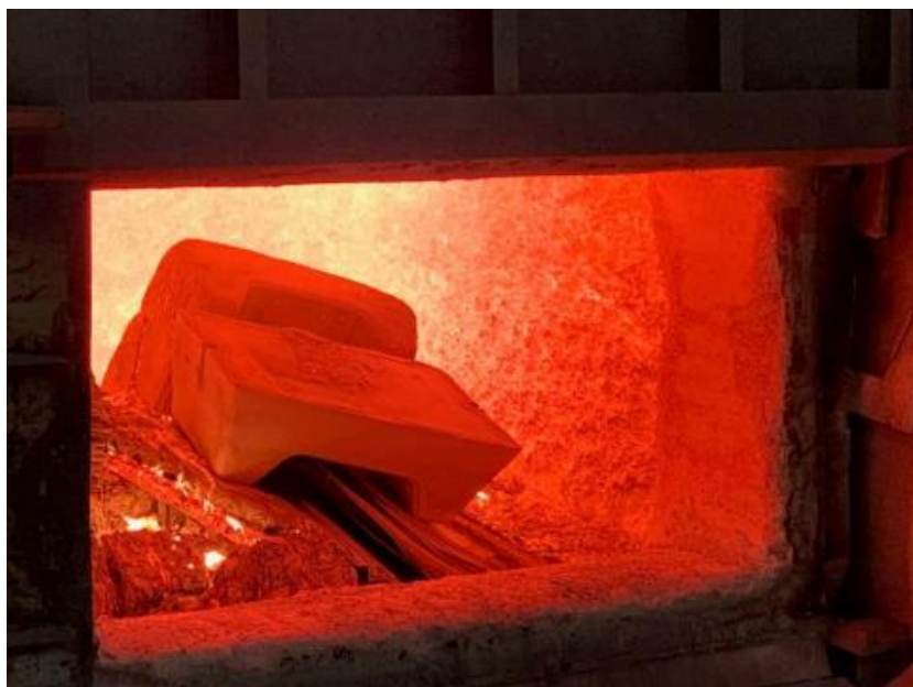
Foto 4: stato del materiale dopo 30 minuti di fusione
