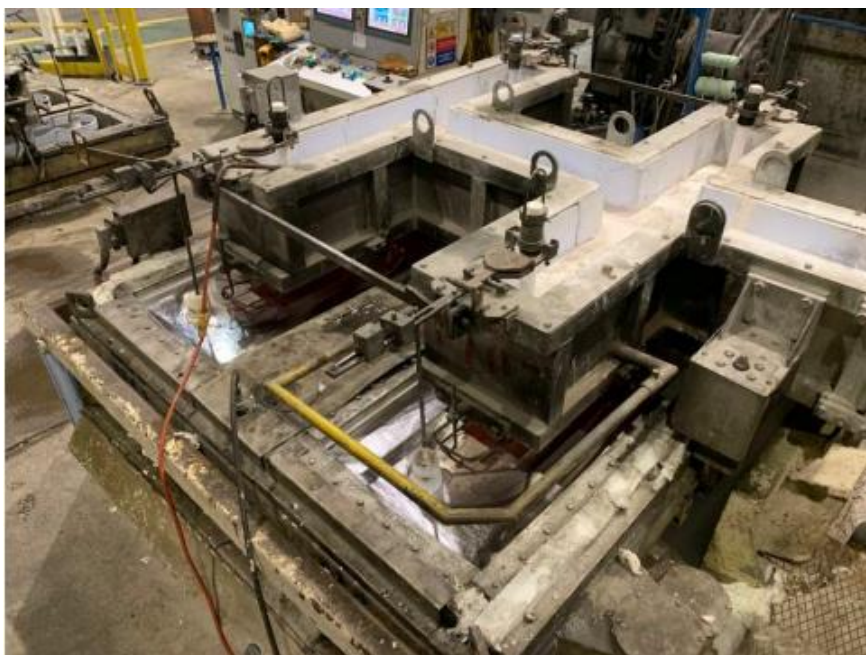
Foto 7: macchina per la colata delle placche
