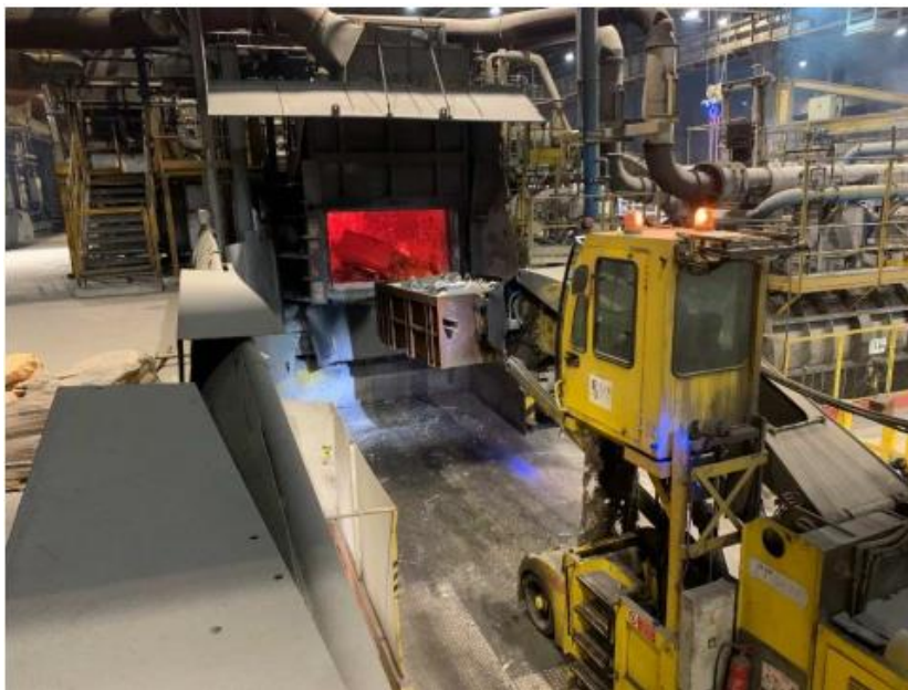
Foto 4 : caricamento di un forno fusorio
