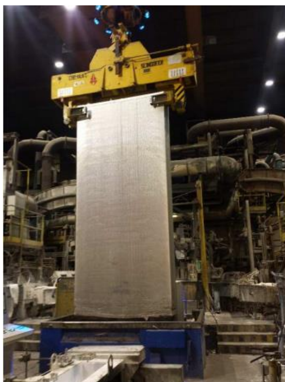
Foto 8: estrazione delle placche dal forno di colata
