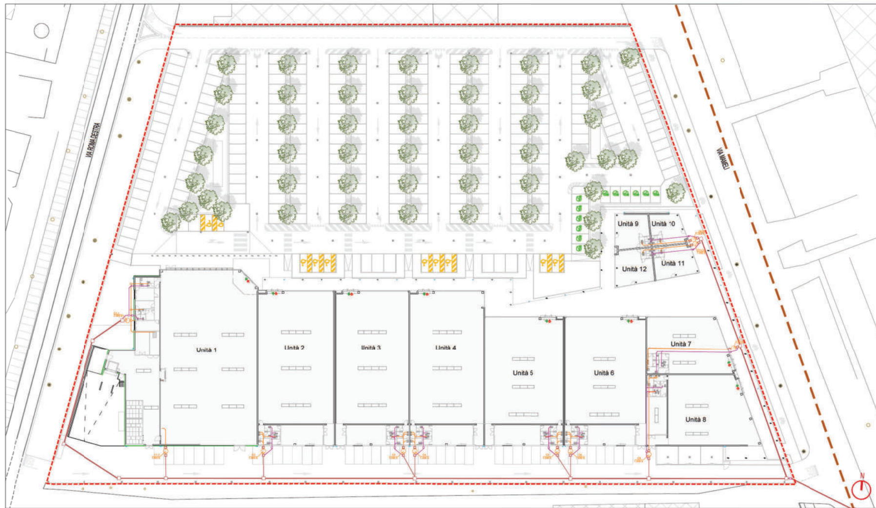
PLANIMETRIA GENERALE - Rete fognaria acque reflue - Scala 1:500
