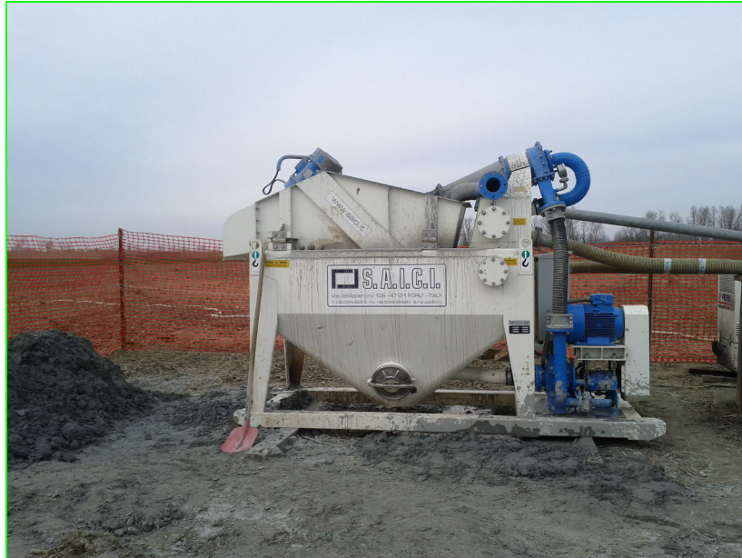
Figura 3 – Esempio di vibrovaglio utilizzato in cantiere.
