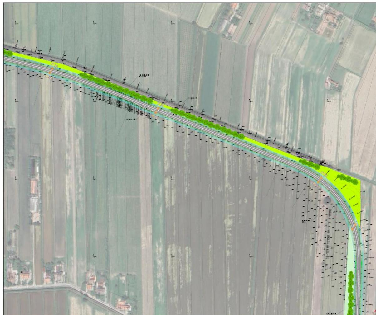
Figura 183 - Estratto Tavola 1370.0.F.J.004.0.D.0\_Mitigazione ambientale procedendo verso Nord-Ovest con il tracciato che costeggia il corso del canale Settimo Novo. Le frecce arancioni indicano gli ecodotti, la campitura verde chiara le aree di mitigazione con semina di tappeto erboso; sul lato nord della bretella, lungo il Canale VII Nuovo si propone la messa dimora di un filare arboreo-arbustivo che, oltre alle funzioni ecologica e paesaggistica, funge da frangivento.
