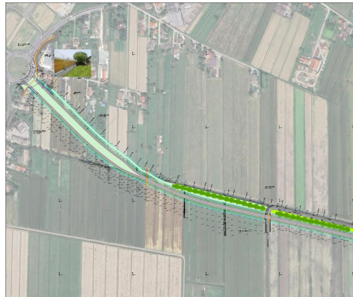
Figura 184 - Estratto Tavola 1370.0.F.J.005.0.D.0\_Mitigazione ambientale nel tratto finale sulla rotonda della SP 42. Le frecce arancioni indicano gli ecodotti, la campitura verde chiara le aree di mitigazione con semina di tappeto erboso; sul lato nord della bretella, lungo il Canale VII Nuovo si propone la messa dimora di un filare arboreo-arbustivo che, oltre alle funzioni ecologica e paesaggistica, funge da frangivento.
