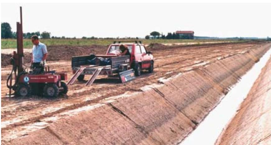
Fig. 4.1. Sonda meccanica della provincia di Venezia presso località Comos di Lugugnana. Lungo la parete del fosso si nota un orizzonte organico sepolto dai depositi fluviali dell'unità di Lugugnana (foto Fontana A.).
